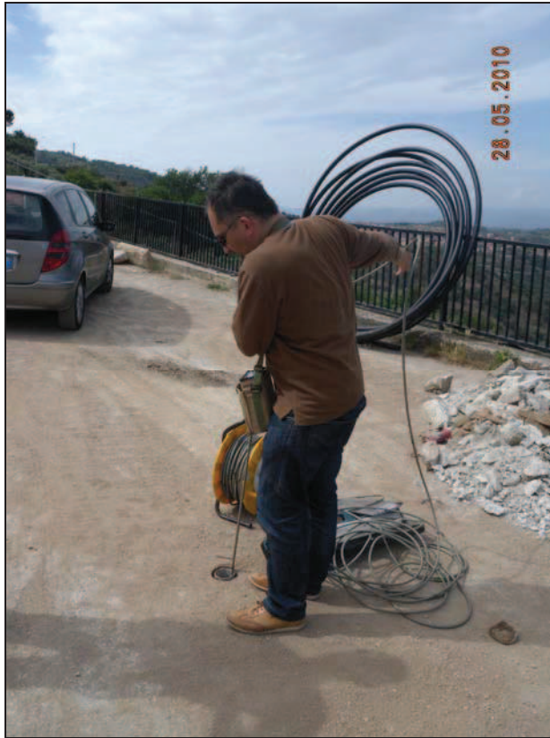
Foto 7 – Lettura inclinometrica del 28/05/2010
