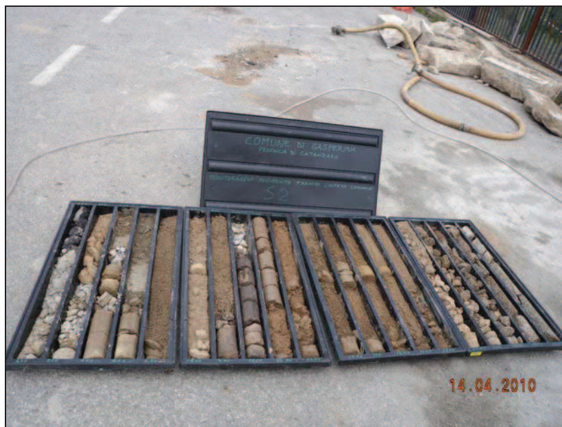
FOTO 4: Cassette catalogatrici con il materiale carotato nel sondaggio S 2
