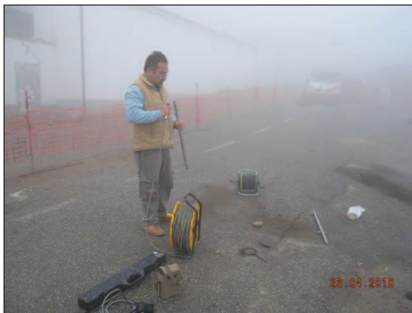
Foto 6 – Lettura inclinometrica di zero.
