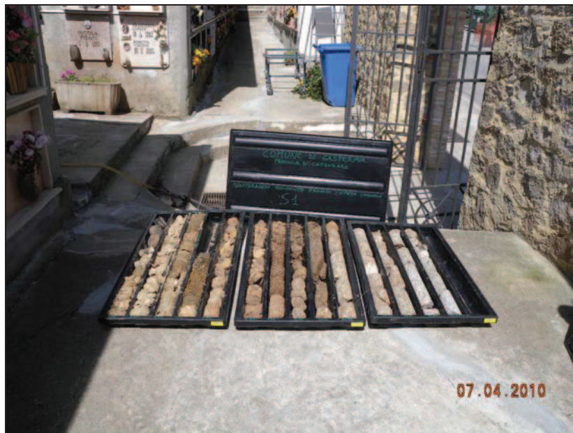
FOTO 2: Cassette catalogatrici con il materiale carotato nel sondaggio S 1
