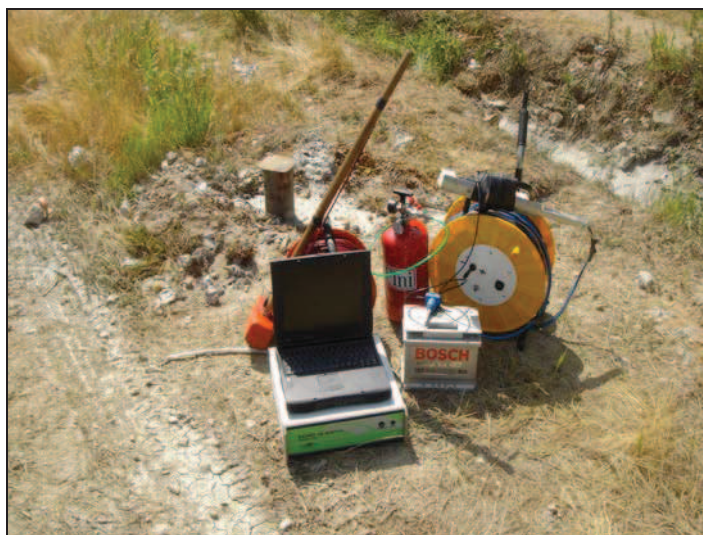
Foto 5 - Sismografo 24 canali Ambrogeo mod. Echo 24/2002 Seismic UNIT.
